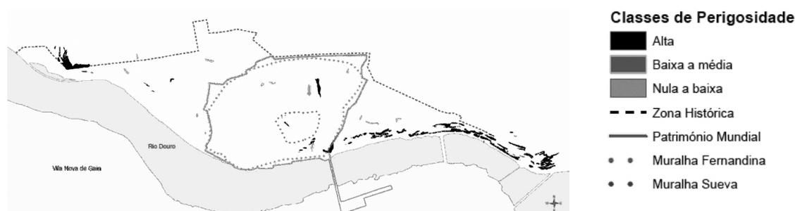
Figura 6 – Carta de Perigosidade de Instabilidade de Taludes
