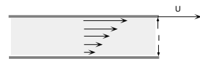
Figura 1.6: para mover a placa a velocidade uniforme é necessário manter uma força aplicada. O deslizamento de camadas de líquido origina tensões de corte.
