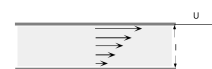
Figura 6: para mover a placa a velocidade uniforme é necessário manter uma força aplicada. O deslizamento de camadas de líquido origina tensões de corte.
