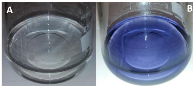
**Figura 3.1:** **A)** Cor da solução titulada no início da titulação do ácido sulfuroso na fração destilada de vinho do Porto na presença do indicador de cozimento de amido. **B)** Cor da solução titulada no ponto final da titulação.
