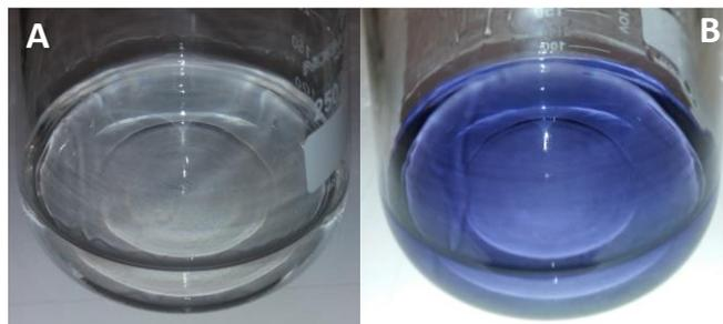
**Figura 3.1:** **A)** Color de la solución titulada en el inicio de la titulación del ácido sulfuroso en la fracción destilada de vino de Oporto y después de la adición de almidón. **B)** Color de la solución titulada en el punto final de la titulación.
