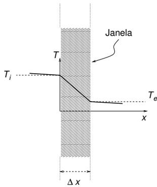
Figura 5.7: No interior do vidro de uma janela, a temperatura varia entre o valor da temperatura interior,  $T_i$ , e exterior,  $T_e$ .
