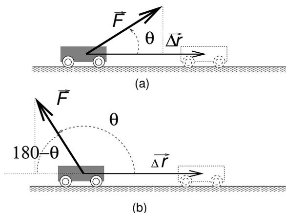
Figura 2.18: No caso (a) o trabalho da força é positivo (o carrinho recebe energia), no caso (b) negativo (cede energia). Em qualquer dos casos é dado por  $F\Delta r \cos \theta$  em que  $F$  e  $\Delta r$  são os módulos da força e do deslocamento, respectivamente.
