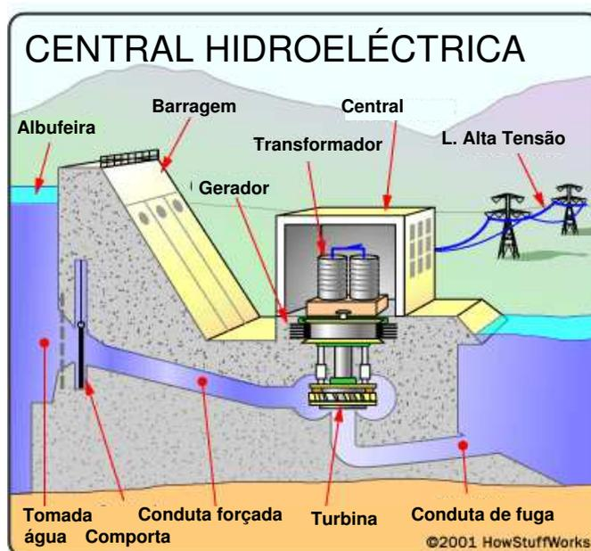
Figura 1.2: Esquema de um aproveitamento hidroelétrico (adaptado de [8]).
