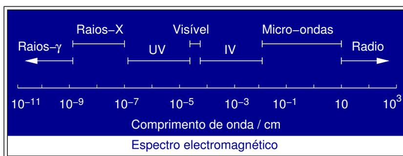
Figura 6.1: Espectro Electromagnético.
