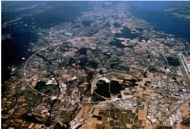
Figura 3.1: Fotografia aérea do CERN, junto ao lago Genebra. Estão marcados na foto alguns dos anéis aceleradores deste laboratório. O maior ocupa um túnel de 27 km de perímetro [3].
