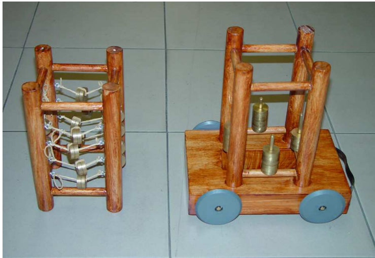
Figura 12: Carro para demonstração de colisões inelásticas. O carro é constituído por uma base com rodas, e dois acessórios, que podem ser montados na base, em alternativa. Têm a mesma massa total, mas, num deles, os discos metálicos podem mover-se relativamente à estrutura de madeira. [4].
