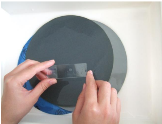
Fig. 4: Desgaste dos otólitos montados em lâmina com Entellan.
