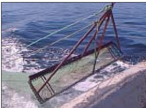
Figura 17 - Ganchorra do norte, mostrando a boca e o respectivo saco de rede (Fonte: Ipimar)
