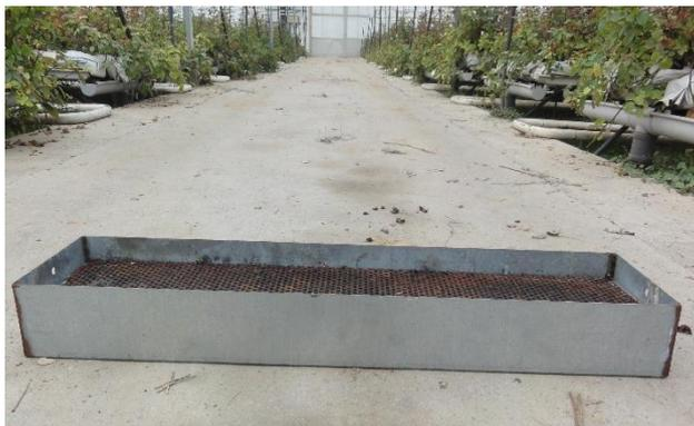
Figura 3. Lisímetro de drenagem ou volumétrico onde é possível ver a malha metálica que suporta o saco com o substrato e as plantas.
